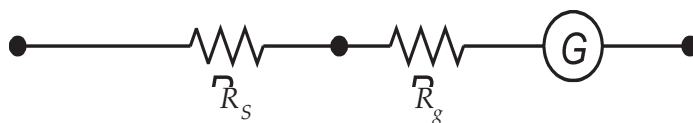
Gambar 5.19. Susunan suatu voltmeter dengan menggunakan galvanometer G dengan hambatan dalam R_g dan suatu hambatan R_s
